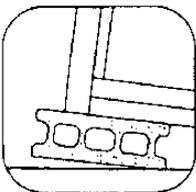
ブロック・束石・アスファルト・地面直接などに設置しないでください。基礎土台は、必ず鉄筋コンクリート(圧縮強度FC=210kgf/cm<sup>2</sup>・養生期間28日以上)で指定寸法以上にしてください。
