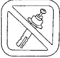
アンカーボルトの穴はドリル刃  $\phi 16.5$  を使用してください。
