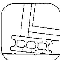
ブロック・束石・アスファルト・地面直接などに設置しないでください。
