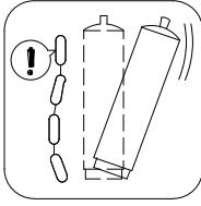
容器の転倒によるガスもれ防止のためチェーンを必ず取り付けてください。
