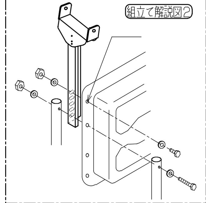
タンク脚を固定する六角ボルトで左右の脚を図の様（タンク正面より見て脚部ボルト穴が背面）に固定します。
