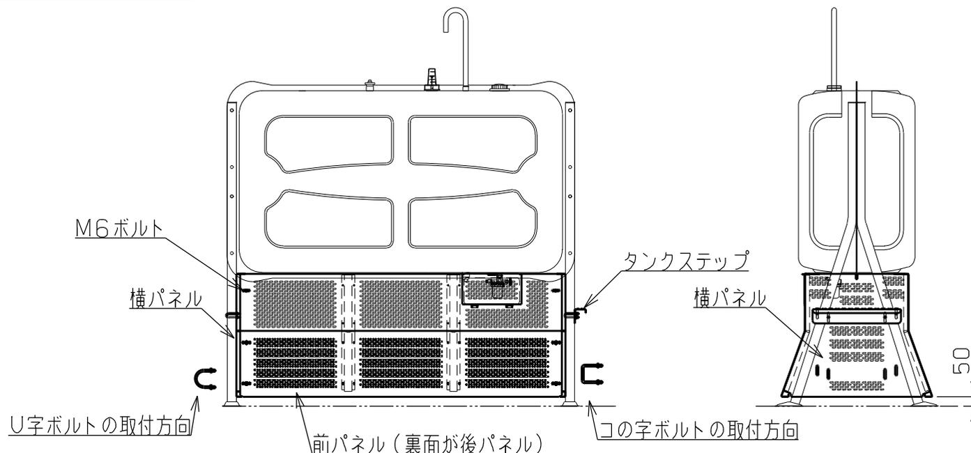
1. タンク正面に向かって右側に横パネルとタンクステップをコの字ボルトで取り付けます
