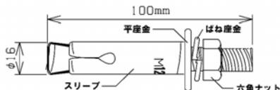
① 鉄筋コンクリート基礎（圧縮強度  $F_C = 210 \text{ kgf/cm}^2$ 、養生期間28日以上）の上に設置してください。
