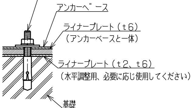
※アンカーボルトの取付は所定の方法に従って下さい。
