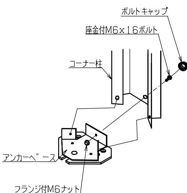
中柱・アンカーベースの取付
