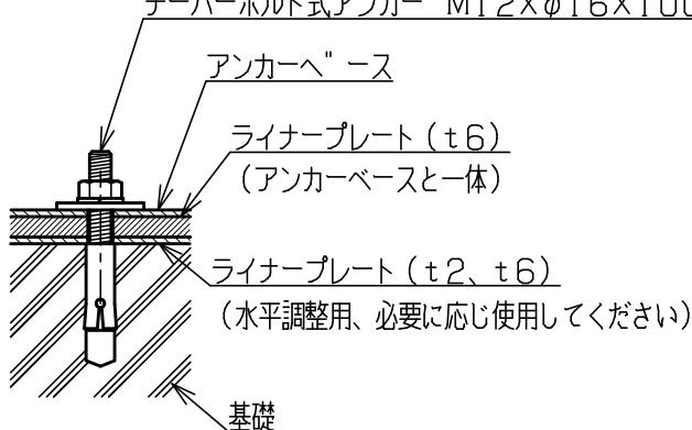
※アンカーボルトの取付は所定の方法に従って下さい。
